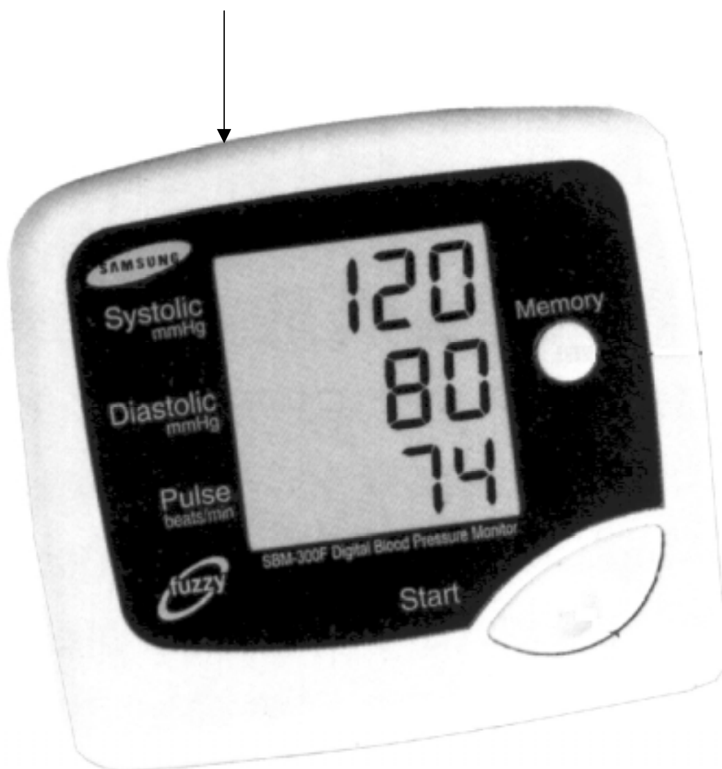
Slika 2: Izgled tlakomjera tip SBM-300F s prikazom mjesta za smještaj ovjerne naljepnice
